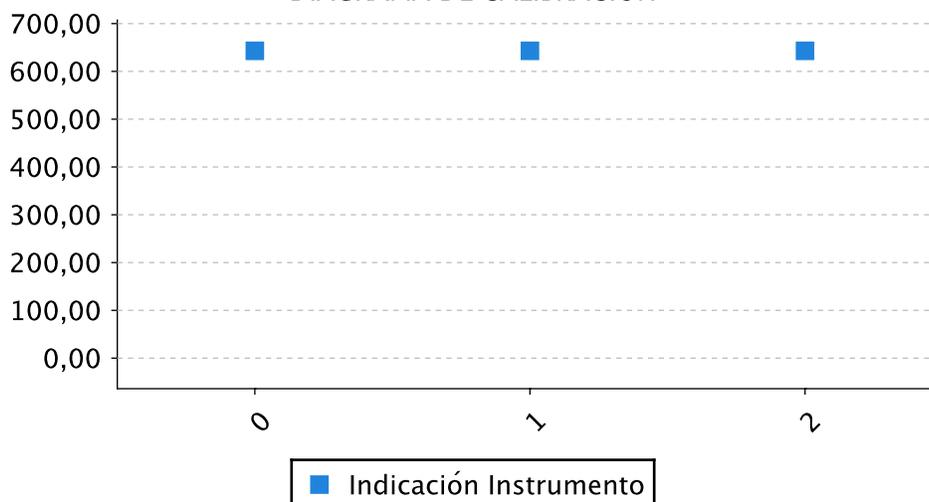
El porcentaje de error + incertidumbre (U) obtenido NO es permitido en detectores de gas portatil en base a las tolerancias descritas en el manual del equipo. Se requiere ajustar el equipo para disminuir el error del instrumento y efecturar una nueva calibración.
